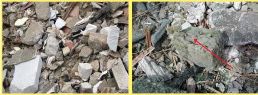
Abbildung 48: Gemischter Bauschutt – nicht gelisteter Abfall
