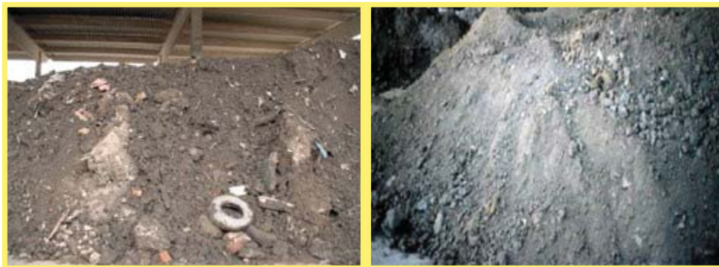
Abbildung 243: Erdaushub aus Deponiesanierung
