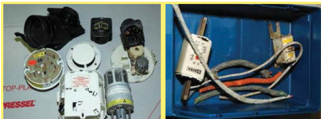
Abbildung 107: Radioaktive Bauteile (ggf. treffen Strahlenschutzbestimmungen zu) – A1180 Abbildung 108: Asbesthaltiger Elektronikschrott – A1180 oder A2050
