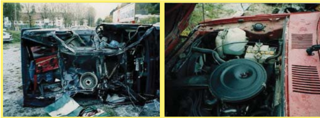
Abbildung 113: Autowrack, nicht schadstoffentfrachtet – nicht gelisteter Abfall
