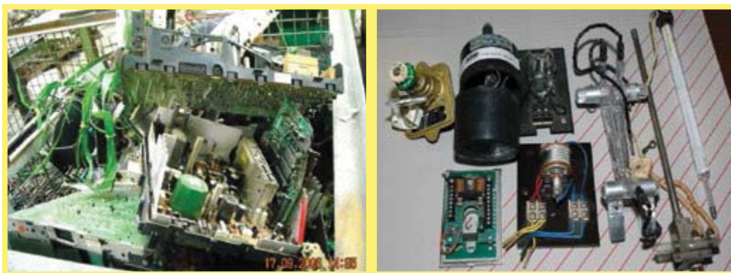
Abbildung 105: Mit gefährlichen Bauteilen bestückte Platinen – A1180 Abbildung 106: Quecksilberhaltige Bauteile – A1030
