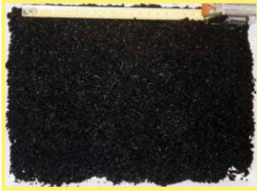
Abbildung 16: Kontaminierte Aktivkohle aus der Wasserreinigung – A4160
