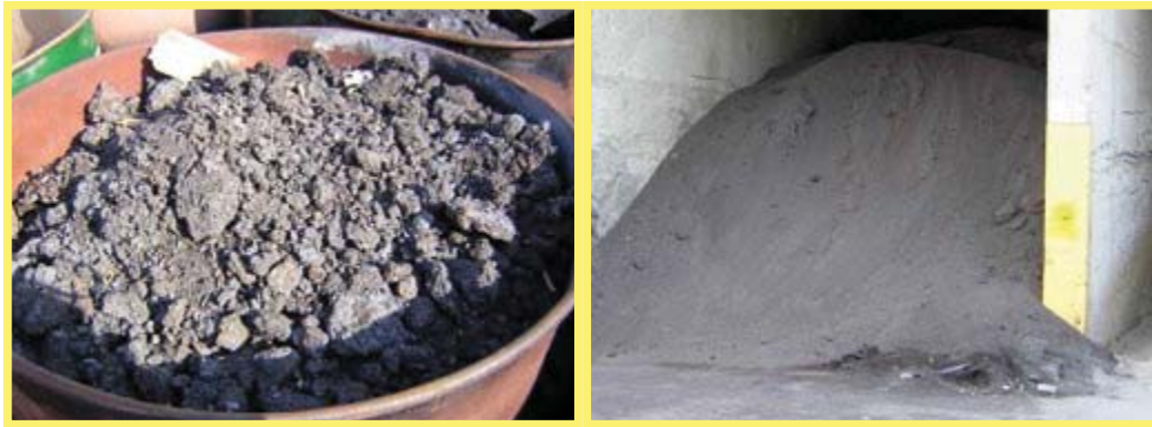
Abbildung 196: Kupferraffinationsmaterial mit mehr als 0,3 % Bleiverbindungen – Gefahrenmerkmal HP10 gemäß EG-Rechtslage – nicht gelisteter Abfall oder A1020
