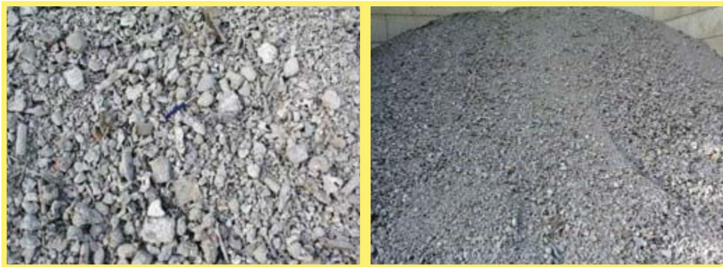
Abbildung 213: Metallkonzentrat, hauptsächlich Aluminium, aus Verbrennungsschlacken, Metallanteil unter 90 % – nicht gelisteter Abfall
