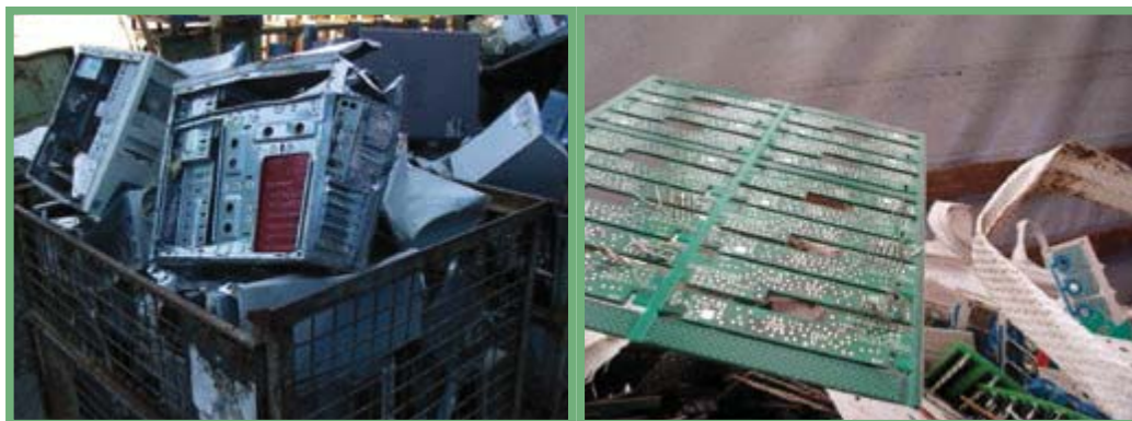
Abbildung 95: Ausgebaute, nicht funktionsfähige CPUs Abbildung 96: Leiterplatten ohne gefährliche Bauteile
