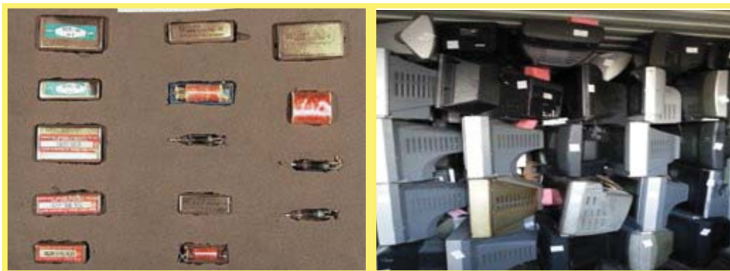
Abbildung 111: Alte Quecksilberkontakte – A1030 Abbildung 112: Alte Bildschirmgeräte, unverpackt und ohne Prüfzertifikate der Funktionsfähigkeit – gefährlicher Abfall – A1180
