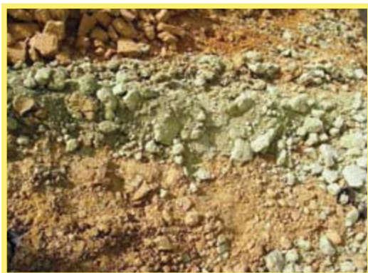
Abbildung 123: Verunreinigter Gips, dessen Verwertung nicht gesichert ist – AB150
