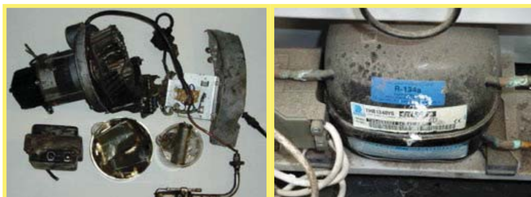
Abbildung 83: Elektromotor mit PCB-Anlasskondensator – A1180
