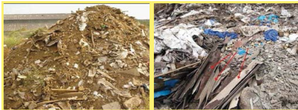
Abbildung 46: Gemischter Bauschutt – nicht gelisteter Abfall
