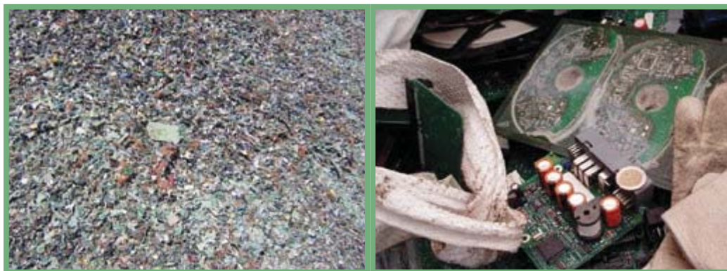
Abbildung 89: Geshredderte Leiterplatten, die vorher von gefährlichen Bauteilen befreit wurden Abbildung 90: Leiterplatten ohne gefährliche Bauteile (Elektrolytkondensatoren unter 25 mm Größe)
