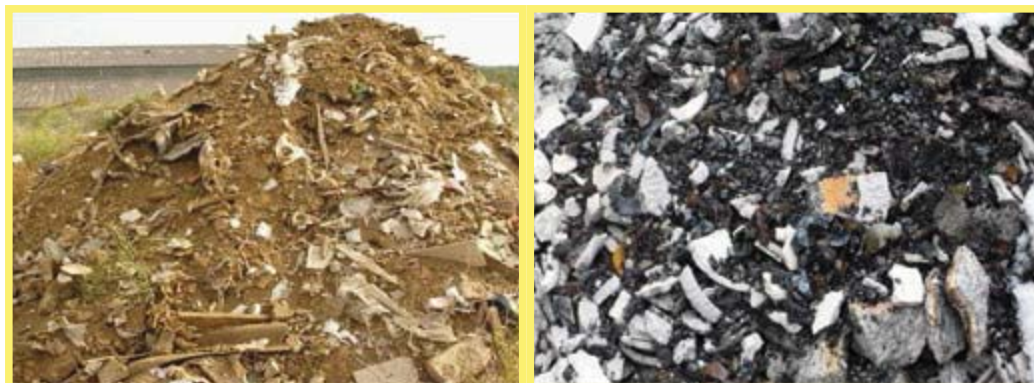
Abbildung 163: Gemischter Bauschutt – nicht gelisteter Abfall
