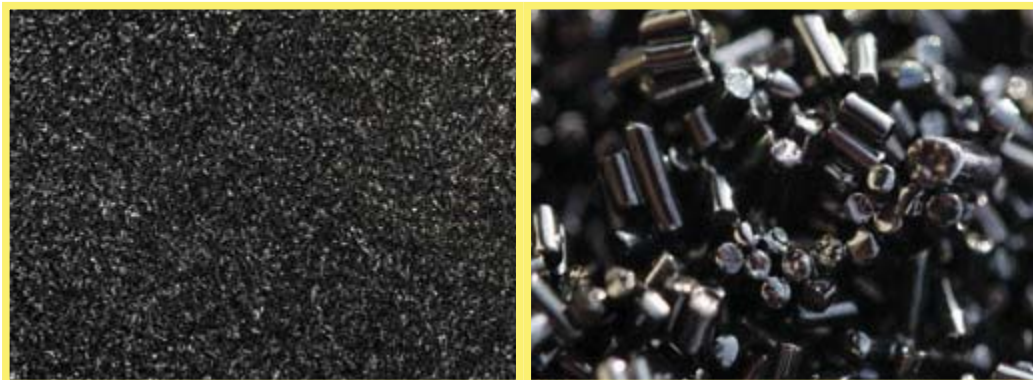
Abbildung 157: Vanadiumkatalysator mit gefährlichen Verunreinigungen – A2030
