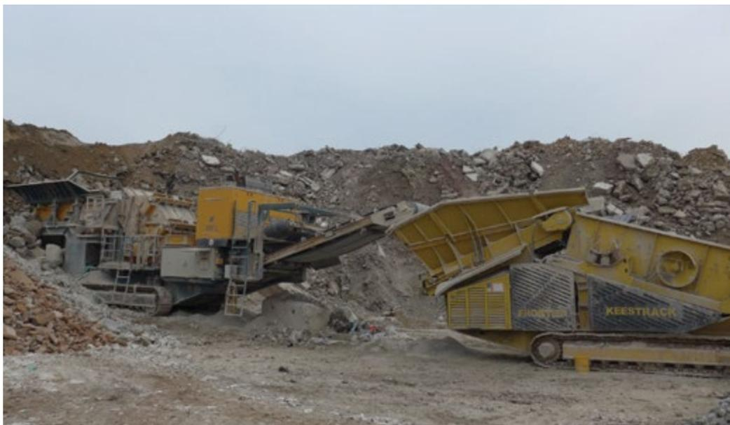
Abbildung 67: Mobile Anlage zur Aufbereitung von mineralischen Baurestmassen
