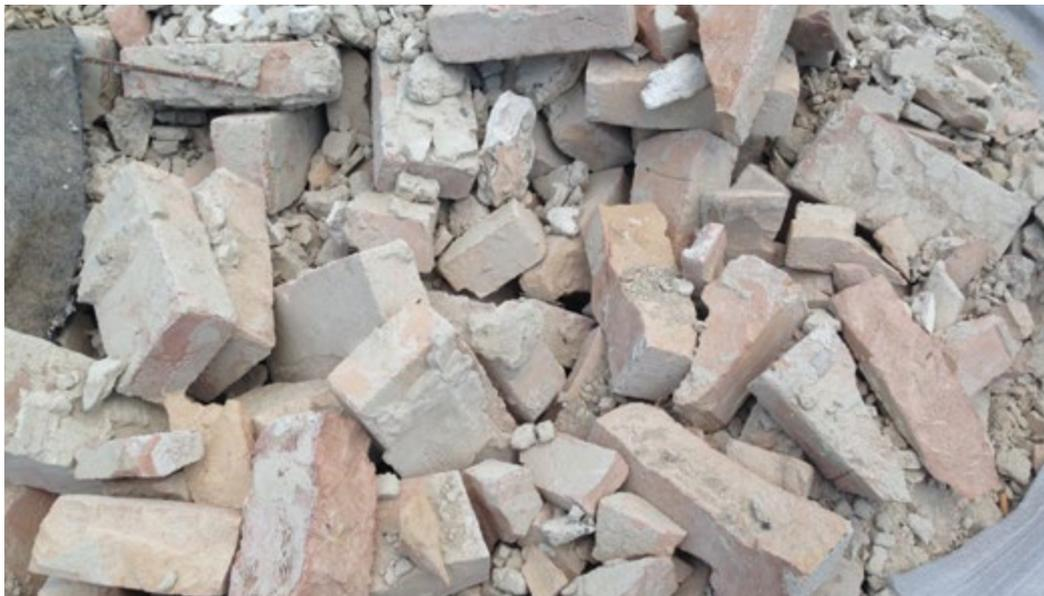
Abbildung 108: Mineralische Bauabfälle von einem Gebäudeabbruch
