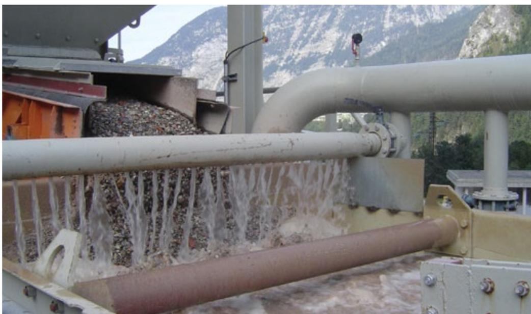
Abbildung 68: Nassaufbereitung von mineralischen Baurestmassen
