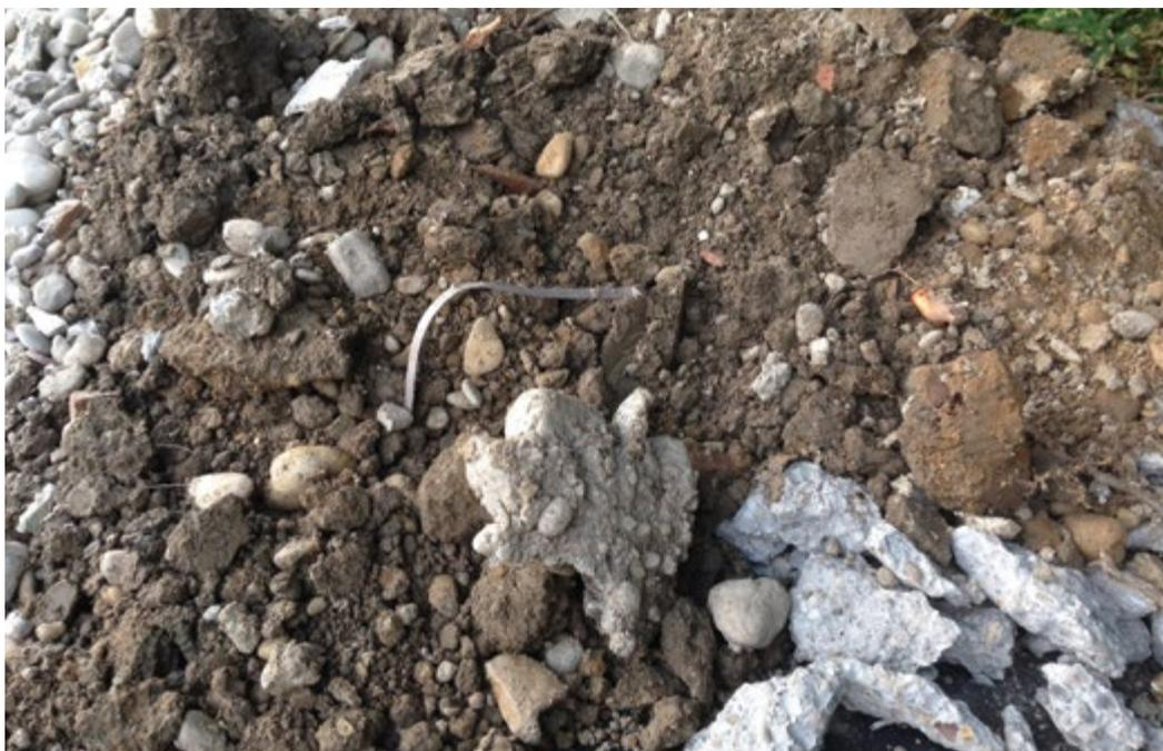
Abbildung 142: Verunreinigtes Aushubmaterial
